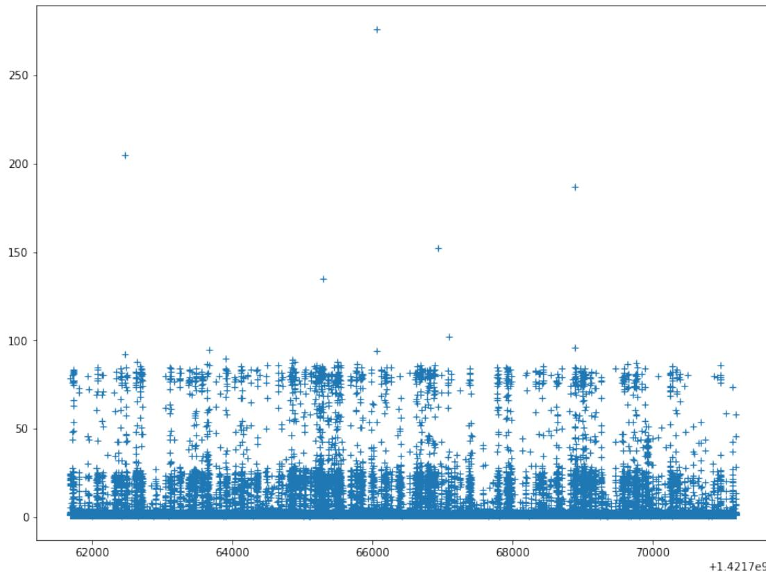
A première vue, le temps ne semble pas impacter la durée d'envoi. Les zooms à plusieurs endroits renforcent cette opinion. En effet, les durées d'envoi sont généralement inférieures à 3 ms et des pics apparaissent de temps en temps peu importe le temps écoulé.
